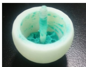
図1. 逆立ちコマ。粘土を入れて、重心位置を調整した。
