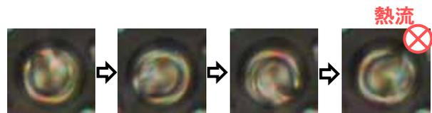
図 3:U 字型液晶滴における熱駆動回転運動(間隔:400msec、熱流:6.0mW/mm<sup>2</sup>)
