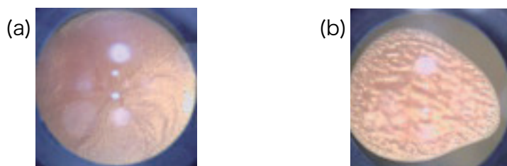
図1 塗料の乾燥後の表面の様子。(a)ガラス基板の場合(b)プラスチック基板の場合
